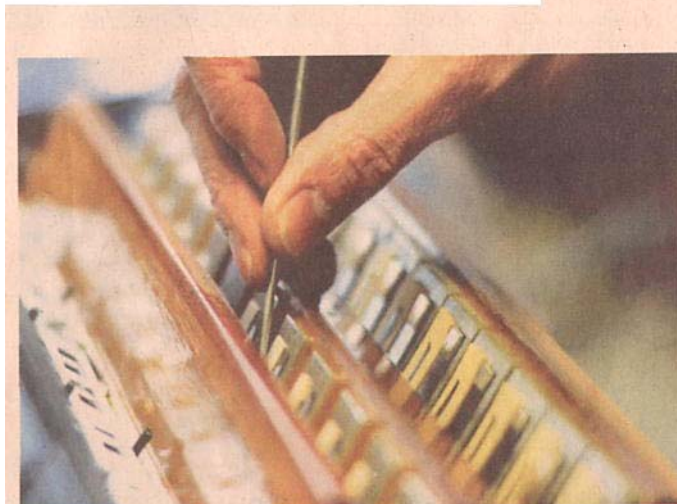
Nicchie. Per ogni fisarmonica vengono assemblati a mano 5mila pezzi
